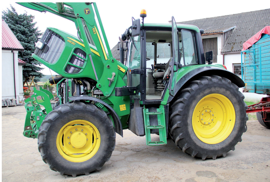
John Deere 6630 po tuningu uzyskał na silniku mocy 147 KM mocy maksymalnej i 616 Nm maksymalnego momentu obrotowego.
