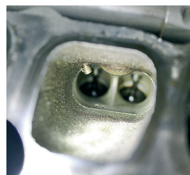
Mazda CX9 (ta sama co wykres). Widoczne nieodpowiednie zamontowanie m.in. dyszy rozpylacza, a to tylko jedna z wielu wykrywanych nieprawidłowości
