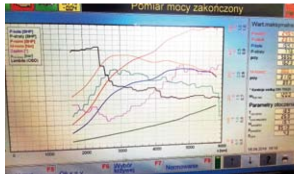
Pomiar fabrycznych nastaw to niższe wartości mocy i bardzo duża detonacja. Już po pierwszym etapie minimalizowania LSPI i SPI odnotowano znaczącą poprawę
