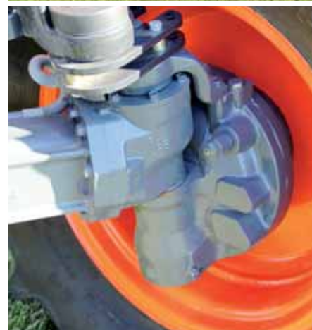
Most ze zwrotnicami stożkowymi sprawia, że zwrotność Kuboty jest naprawdę duża.
