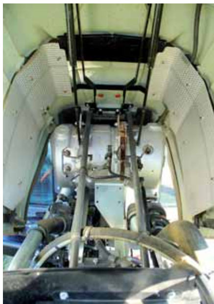
Filtr DPF umieszczony jest za silnikiem, tuż przy kabynie.
