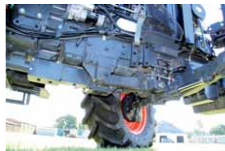
Amortyzacja przedniej osi działa bez zarzutu i daje jej dobry docisk do podłoża zarówno na polu, jak i na drodze.
